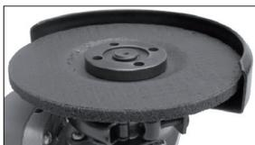
Concernant les disques plus fins, la bride doit être vissée sur le collier pointant vers l'extérieur.
