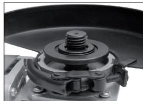
→ Veuillez noter que le disque ne doit pas toucher le capot lorsqu'il est en rotation. Concernant les disques excentrés, la partie excentrée doit pointer à l'opposé du boîtier, sinon le disque pourrait frotter contre le capot.
