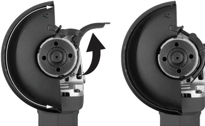
→ Lors de l'installation du capot de protection, aucun disque ne doit être fixé. Veuillez toujours utiliser le capot de protection lorsque vous découpez ou meulez.
