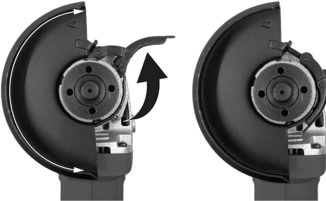
→ Bij de montage van de beschermkap mag geen schijf gemonteerd zijn. Gebruik de beschermkap altijd bij het snijden of slijpen.
