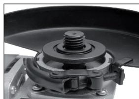
→ Let op dat de schijf de afscherming niet mag raken tijdens het draaien. Bij afbraamschijven moet de bocht uit de buurt van de behuizing wijzen, omdat de schijf anders tegen de beschermkap zou slijpen.
