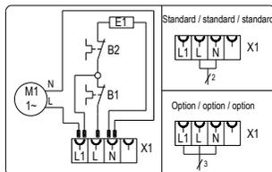
Phase L and L1 müssen die gleiche Phasenlage haben / Phase L and L1 must have the same phasing
