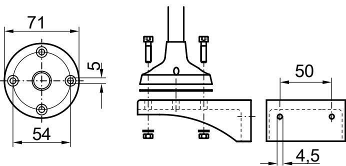
Rohrmontage / Instalación en tuberías
