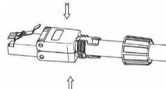
5. Schließen Sie das Metallgehäuse in dem Sie beide Seiten zusammendrücken.
