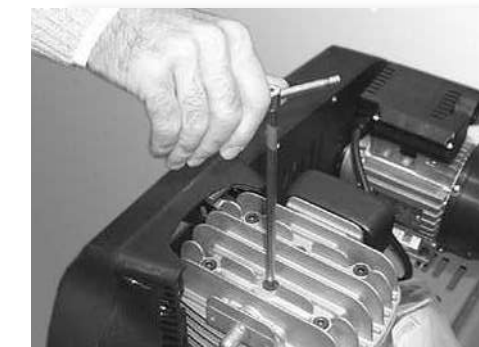
Zylinderkopfschrauben nach der 1. Arbeitsstunde kontrollieren eventuell nachziehen.
