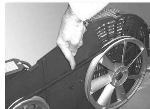
Riemenspannung kontrollieren. Leichtes Durchdrücken muss gewährleistet sein.
