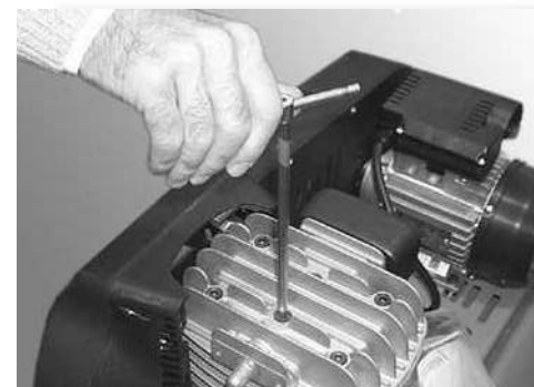
Zylinderkopfschrauben nach der 1. Arbeitsstunde kontrollieren eventuell nachziehen.
