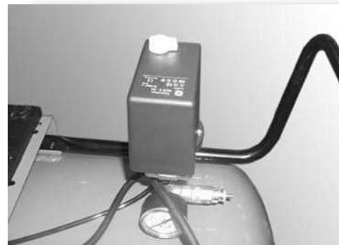
Druckentlastung durch Schalter
