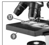
Leg nu een houdbaar preparaat (17) direct onder het objectief op de microscooptafel. Het te observeren object dient hierbij precies boven het lampje (10) te liggen.
