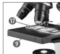
Ahora coloca una preparación permanente (17) en la mesa del microscopio directamente bajo el objetivo. Para ello, el objeto a observar debe estar colocando exactamente sobre la iluminación (10).
