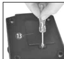
In de voet van de microscoop bevindt zich het batterijvak (13). Verwijder de schroef op het deksel van het batterijvak met een geschikte kruisschroevendraaier en verwijder het deksel van het batterijvak. Leg nu de batterijen zo in de vakken dat de platte minpolen (-) van de batterijen tegen de veerklemmen drukken en de pluspolen (+) van de batterijen dan de platte contactplaatjes raken. Sluit het batterijvak met het deksel en draai de microscoop weer terug.
