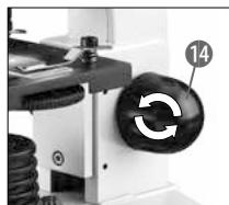
Em primeiro lugar, desloca (14) a mesa do microscópio (9) totalmente para baixo. Em seguida, gira o revólver das objectivas (6) até encaixar na ampliação mais reduzida (objectiva 4x).
