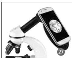
Die Smartphone-Halterung wird auf das Okular aufgesteckt.
