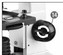
Breng de microscooptafel (9) helemaal naar beneden. Draai vervolgens de objectiefrevolver (afb. 1, 8) zo ver door, dat hij op de laagste vergroting (objectief 4x) vastklikt.
