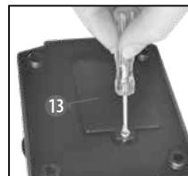
Im Fuß des Mikroskops befindet sich das Batteriefach (13). Die Schraube am Batteriefachdeckel mit einem geeigneten Kreuzschraubendreher entfernen und Batteriefachdeckel abnehmen. Legt nun die Batterien in die Kammern so ein, dass die flachen Minuspole (-) der Batterien gegen die Federklemmen drücken und die Pluspole (+) der Batterien dann die flachen Kontakt-Bleche berühren. Verschließe das Batteriefach mit dem Deckel und drehe das Mikroskop wieder um.
