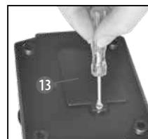
Nella base del microscopio si trova il vano batterie (13). Aprire delicatamente il coperchio del vano batterie. Inserisci le batterie in modo tale che l'estremità piatta della batteria, cioè il polo negativo (-), prema contro il morsetto a molla e che il polo positivo (+) sia a contatto con il lamierino. Chiudi nuovamente il vano batterie con il coperchio e raddrizza nuovamente il microscopio.
