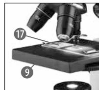
Nun lege ein Dauerpräparat (17) direkt unter dem Objektiv auf den Mikroskopisch. Das zu beobachtende Objekt soll hierbei genau über der Beleuchtung (10) liegen.
