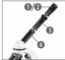
Schuif nu het 10x oculair (1) in de Barlow-lens (3). Let erop dat de Barlow-lens helemaal in de oculairbus (4) zit en er niet half is uitgetrokken.
