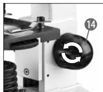
Fahre den Mikroskopisch (9) zunächst ganz hinunter (14). Dann drehe den Objektivrevolver (6) so weit, bis er auf der niedrigsten Vergrößerung (Objektiv 4x) einrastet.
