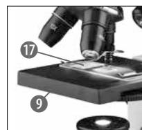
Agora coloca um preparado permanente (17) directamente por baixo da objectiva na mesa do microscópio (fig. 3). O objecto a ser observado deve encontrar-se mesmo por baixo da iluminação (10).
