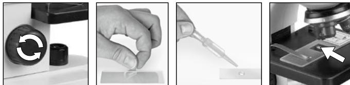
Поставьте микроскоп в хорошо освещенное место, например у окна или рядом с настольной лампой. Выберите объектив (3) с наименьшим увеличением и поворачивайте ручки фокусировки (2)
