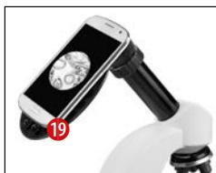
Die Smartphone-Halterung wird auf das Okular aufgesteckt.
