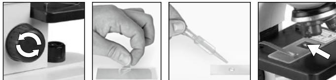
Para la observación normal, debes colocar el microscopio en un lugar donde haya claridad (junto una ventana o un flexo). Gira el tornillo micrométrico (2) hasta el tope superior y ajusta el revólver con objetivos (3) al aumento más pequeño.
