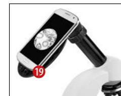
L'adaptateur de Smartphone est fixé à l'oculaire du microscope.
