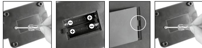
Для наблюдений с подсветкой (6) вставьте 2 батарейки AA 1,5 В в батарейный отсек (8), расположенный в основании микроскопа (7). Батарейный отсек можно открыть с помощью крестовой отвертки. При установке батареек соблюдайте полярность (обозначена зна-
