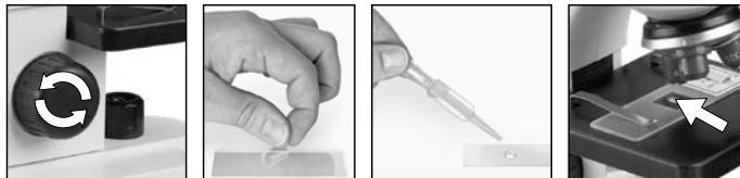
Für die normale Beobachtung stellst du das Mikroskop an einen hellen Platz (Fenster, Tischlampe). Das Scharfeinstellungsrad (2) wird bis zum oberen Anschlag gedreht und der Objektiv-Revolver (3) wird auf die kleinste Vergrößerung eingestellt. Schalte nun die Beleuchtung über den
