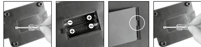
Zur Beobachtung mit der elektrischen Beleuchtung (6) benötigst du 2 AA Batterien mit 1,5 V, die im Batteriefach (8) am Mikroskop-Fuß (7) eingesetzt werden. Das Batteriefach wird mit Hilfe von einem Kreuzschraubenzieher geöffnet. Achte beim einlegen der Batterien auf die richtige
