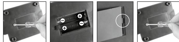
Para la observación con la fuente de luz electrónica (6) necesita insertar 2 AA pilas de 1.5V, en el compartimento de las pilas (8) en la base del microscopio (7). El compartimento de las pilas se abre usando un destornillador Phillips. Inserte las pilas con la polaridad correcta (+/- indicación).
