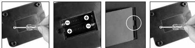
Pour l'observation de la source de lumière électronique (6), vous devez insérer 2 piles AA 1.5V, dans le compartiment de la batterie (8) sur la base
