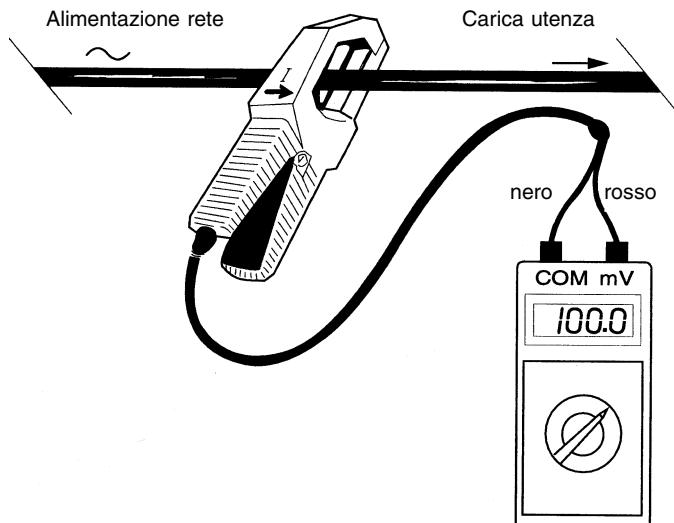
**⚠** Da 500 A à 600 A, limitare il tempo d'impiego della pinza: 10 minutes di funzionamento e 30 minutes di fermo.
