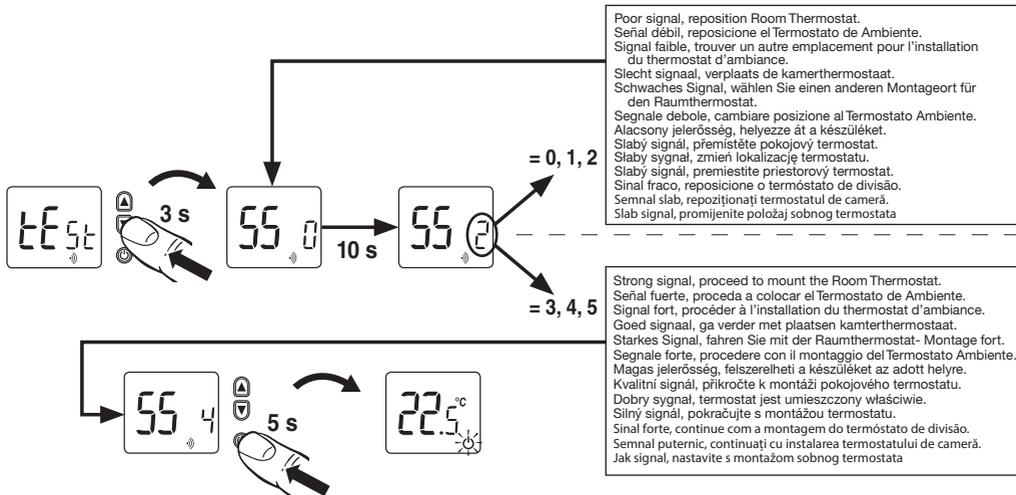
3.5 **GB** Mounting the Room Thermostat **E** Colocación del Termostato de Ambiente **F** Installation du thermostat d'ambiance
