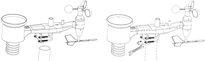
Stellen Sie anhand der Markierung mit der Aufschrift „WEST“ sicher, dass die Sensorkomponente korrekt ausgerichtet ist.
