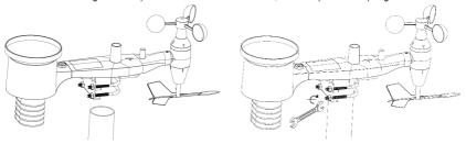
Stellen Sie anhand der Markierung mit der Aufschrift "WEST" sicher, dass die Sensorkomponente korrekt ausgerichtet ist.
