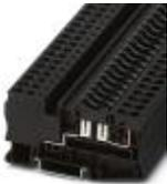
Sicherungsreihenklemme, Art der Sicherung: Flach, Anschlussart: Zugfederanschluss, Querschnitt: 0,08 mm<sup>2</sup>- 6 mm<sup>2</sup>, AWG: 28 - 10, Nennstrom: 30 A, Nennspannung: 400 V, Breite: 8,2 mm, Sicherungstyp: C, Montageart: NS 35/7,5, NS 35/15, Farbe: schwarz
