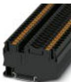
Sicherungsreihenklemme, Art der Sicherung: Flach, Anschlussart: Push-in-Anschluss, Querschnitt: 0,5 mm<sup>2</sup>- 10 mm<sup>2</sup>, AWG: 20 - 8, Nennstrom: 25 A, Nennspannung: 400 V, Breite: 8,2 mm, Sicherungstyp: Typ-C / max. 2,2 W, Montageart: NS 35/7,5, NS 35/15, Farbe: schwarz
