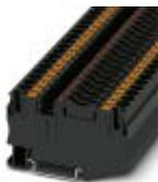
Sicherungsreihenklemme, Art der Sicherung: Flach, Anschlussart: Push-in-Anschluss, Querschnitt: 0,5 mm<sup>2</sup>- 10 mm<sup>2</sup>, AWG: 20 - 8, Nennstrom: 25 A, Nennspannung: 24 V, Breite: 8,2 mm, Sicherungstyp: Typ-C / max. 2,2 W, Montageart: NS 35/7,5, NS 35/15, Farbe: schwarz
