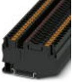
Sicherungsreihenklemme, Art der Sicherung: Flach, Anschlussart: Push-in-Anschluss, Querschnitt: 0,5 mm<sup>2</sup>- 10 mm<sup>2</sup>, AWG: 20 - 8, Nennstrom: 25 A, Nennspannung: 48 V, Breite: 8,2 mm, Sicherungstyp: Typ-C / max. 2,2 W, Montageart: NS 35/7,5, NS 35/15, Farbe: schwarz
