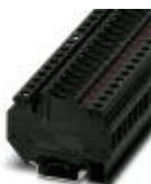
Flachsicherungsklemme, Querschnitt: 0,2-6 mm<sup>2</sup>, AWG: 26-8, Breite: 8,2 mm, Farbe: schwarz, mit Leuchtanzeige, Spannung Leuchtanzeige: 24 V DC, Strom Leuchtanzeige: 2 mA
