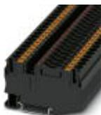
Sicherungsreihenklemme, Art der Sicherung: Flach, Anschlussart: Push-in-Anschluss, Querschnitt: 0,5 mm<sup>2</sup>- 10 mm<sup>2</sup>, AWG: 20 - 8, Nennstrom: 25 A, Nennspannung: 12 V, Breite: 8,2 mm, Sicherungstyp: Typ C / max. 2,2 W, Montageart: NS 35/7,5, NS 35/15, Farbe: schwarz
