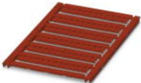
Marker für Klemmen, Matte, rot, unbeschriftet, beschriftbar mit: TOPMARK NEO, TOPMARK LASER, BLUEMARK ID COLOR, BLUEMARK ID, BLUEMARK CLED, THERMOMARK PRIME, THERMOMARK CARD 2.0, THERMOMARK CARD. Montageart: verrasten in flacher Schildchennut, für Klemmenbreite: 5,2 mm, Schriftfeldgröße: 4,4 x 4,7 mm, Anzahl der Einzelschilder: 72
