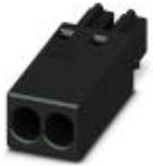
Leiterplattenstecker, Nennstrom: 6 A, Bemessungsspannung (III/2): 160 V, Nennquerschnitt: 0,75 mm<sup>2</sup>, Polzahl: 2, Rastermaß: 2,54 mm, Anschlussart: Crimpanschluss, Farbe: schwarz
