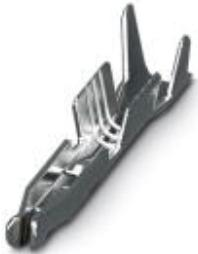
Crimpkontakt, Kontaktart: Buchse (female), Anschlussart: Crimpanschluss, Kontaktobерfläche: Gold, Leiterquerschnitt flexibel: 0,34 ...0,75 mm<sup>2</sup>, Verpackungsart: verpackt im Karton
