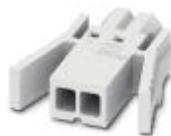
Leiterplattenstecker, Nennstrom: 6 A, Bemessungsspannung (III/2): 160 V, Nennquerschnitt: 0,75 mm<sup>2</sup>, Polzahl: 2, Rastermaß: 2,5 mm, Anschlussart: Crimpanschluss, Farbe: weiß, Kontaktfläche: Zinn
