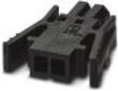
Leiterplattenstecker, Nennstrom: 6 A, Bemessungsspannung (III/2): 160 V, Nennquerschnitt: 0,75 mm<sup>2</sup>, Polzahl: 7, Rastermaß: 2,5 mm, Anschlussart: Crimpanschluss, Farbe: schwarz, Kontaktoberfläche: Zinn
