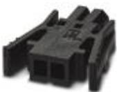
Leiterplattenstecker, Nennstrom: 6 A, Bemessungsspannung (III/2): 160 V, Nennquerschnitt: 0,75 mm<sup>2</sup>, Polzahl: 5, Rastermaß: 2,5 mm, Anschlussart: Crimpanschluss, Farbe: schwarz, Kontaktoberfläche: Zinn
