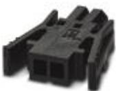
Leiterplattenstecker, Nennstrom: 6 A, Bemessungsspannung (III/2): 160 V, Nennquerschnitt: 0,75 mm<sup>2</sup>, Polzahl: 6, Rastermaß: 2,5 mm, Anschlussart: Crimpanschluss, Farbe: schwarz, Kontaktoberfläche: Zinn
