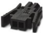
Leiterplattenstecker, Nennstrom: 6 A, Bemessungsspannung (III/2): 160 V, Nennquerschnitt: 0,75 mm<sup>2</sup>, Polzahl: 3, Rastermaß: 2,5 mm, Anschlussart: Crimpanschluss
