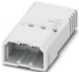
Leiterplattenstecker, Nennstrom: 6 A, Bemessungsspannung (III/2): 160 V, Nennquerschnitt: 0,75 mm<sup>2</sup>, Polzahl: 3, Rastermaß: 2,5 mm, Anschlussart: Crimpanschluss, Farbe: weiß, Kontaktobерfläche: Zinn
