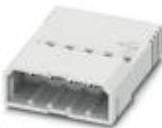
Leiterplattenstecker, Nennstrom: 6 A, Bemessungsspannung (III/2): 160 V, Nennquerschnitt: 0,75 mm<sup>2</sup>, Polzahl: 5, Rastermaß: 2,5 mm, Anschlussart: Crimpanschluss, Farbe: weiß, Kontaktobерfläche: Zinn
