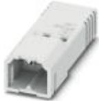
Leiterplattenstecker, Nennstrom: 6 A, Bemessungsspannung (III/2): 160 V, Nennquerschnitt: 0,75 mm<sup>2</sup>, Polzahl: 2, Rastermaß: 2,5 mm, Anschlussart: Crimpanschluss, Farbe: weiß, Kontaktobерfläche: Zinn
