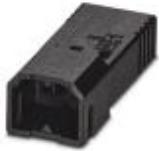
Leiterplattenstecker, Nennstrom: 6 A, Bemessungsspannung (III/2): 160 V, Nennquerschnitt: 0,75 mm<sup>2</sup>, Polzahl: 4, Rastermaß: 2,5 mm, Anschlussart: Crimpanschluss, Farbe: schwarz, Kontaktoberfläche: Zinn
