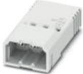
Leiterplattenstecker, Nennstrom: 6 A, Bemessungsspannung (III/2): 160 V, Nennquerschnitt: 0,75 mm<sup>2</sup>, Polzahl: 3, Rastermaß: 2,5 mm, Anschlussart: Crimpanschluss, Farbe: weiß, Kontaktoberfläche: Zinn
