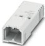
Leiterplattenstecker, Nennstrom: 6 A, Bemessungsspannung (III/2): 160 V, Nennquerschnitt: 0,75 mm<sup>2</sup>, Polzahl: 2, Rastermaß: 2,5 mm, Anschlussart: Crimpanschluss, Farbe: weiß, Kontaktoberfläche: Zinn
