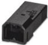
Leiterplattenstecker, Nennstrom: 6 A, Bemessungsspannung (III/2): 160 V, Nennquerschnitt: 0,75 mm<sup>2</sup>, Polzahl: 3, Rastermaß: 2,5 mm, Anschlussart: Crimpanschluss, Farbe: schwarz, Kontaktoberfläche: Zinn
