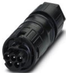
Rundsteckverbinder (kabelseitig), Artikelfamilie: PRC, Steckverbinder, Material Gehäuse: PPE, Farbe: schwarz, Polzahl: 5, Aderquerschnitt min.: 1,5 mm<sup>2</sup>, Aderquerschnitt max.: 6 mm<sup>2</sup>, Nennspannung: 690 V AC, Bemessungsstrom: 35 A, Anschlussart: Schraubanschluss, Kontaktart: Stift, Kabeldurchmesser min.: 8 mm, Kabeldurchmesser max.: 21 mm
