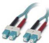
Konfektioniertes LWL-Kabel, Zipcord-Kabel, Glasfaser Multimode 50/125 µm, OM3, Stecker: SC / SC, Schutzart: IP20, für die Verlegung in Kabelkanälen oder Schaltschränken
