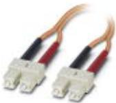
Konfektioniertes LWL-Kabel, Zipcord-Kabel, Glasfaser Multimode 62,5/125 µm, OM1, Stecker: SC-Duplex / SC-Duplex, Schutzart: IP20, für die Verlegung in Kabelkanälen oder Schaltschränken
