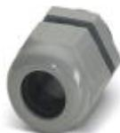
Kabelverschraubung, Material Verschraubung: PA, Kabelaußendurchmesser 6 mm ... 12 mm, Schirmung: nein, Anschlussgewinde: M20 x 1,5, Farbe: silbergrau RAL 7001
