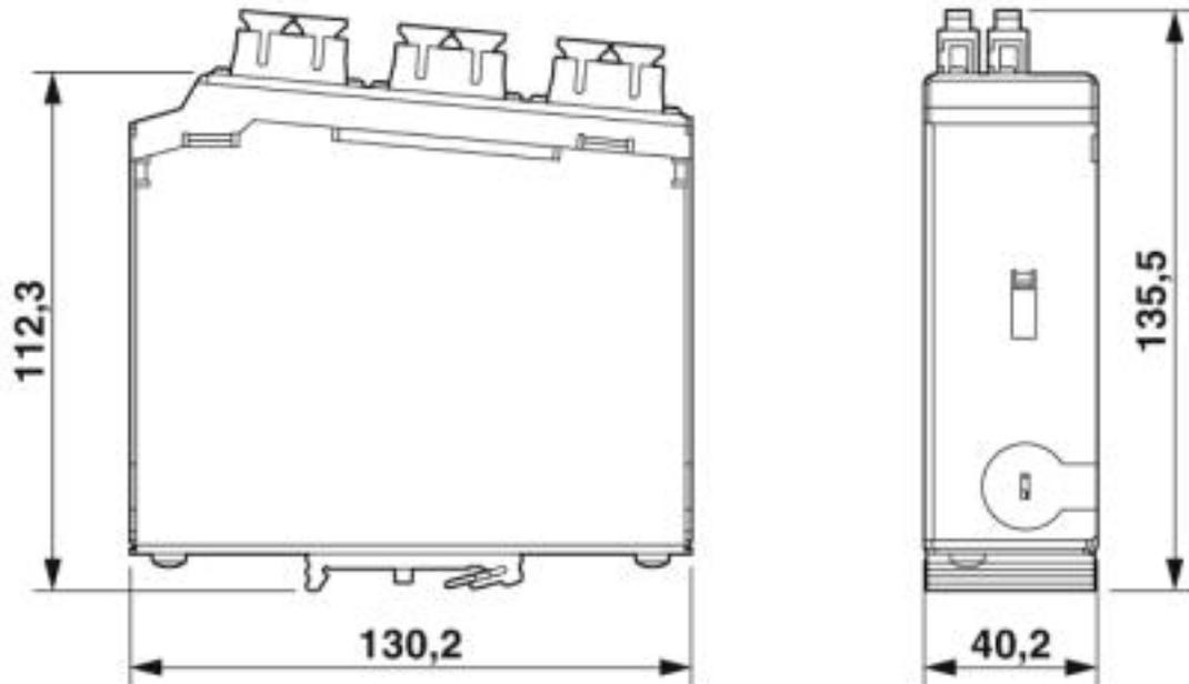
Tragschienen-Verteiler 6x SC-Duplex
