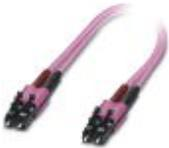
Konfektioniertes LWL-Kabel, Zipcord-Kabel, Glasfaser Multimode 50/125 µm, OM4, Stecker: LC / LC, Schutzart: IP20, für die Verlegung in Kabelkanälen oder Schaltschränken
