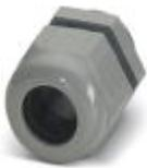
Kabelverschraubung, Material Verschraubung: PA, Kabelaußendurchmesser 6 mm ... 12 mm, Schirmung: nein, Anschlussgewinde: M20 x 1,5, Farbe: silbergrau RAL 7001
