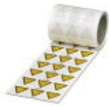
Warnschild, Rolle, gelb/schwarz, unbeschriftet, beschriftbar mit: THERMOMARK ROLLMASTER 300/600, THERMOMARK X1.2, THERMOMARK ROLL X1, THERMOMARK ROLL 2.0, THERMOMARK ROLL, Montageart: kleben, Durchmesser: 0 mm, Schriftfeldgröße: 25 x 25 mm, Anzahl der Einzelschilder: 500
