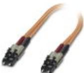
Konfektioniertes LWL-Kabel, Zipcord-Kabel, Glasfaser Multimode 50/125 µm, OM2, Stecker: LC / LC, Schutzart: IP20, für die Verlegung in Kabelkanälen oder Schaltschränken
