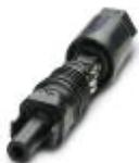
Photovoltaik-Steckverbinder, Artikelfamilie: PV-CF-S, Steckverbinder, Material Gehäuse: PPE, Farbe: schwarz, Polzahl: 1, Aderquerschnitt min.: 2,5 mm<sup>2</sup>, Aderquerschnitt max.: 6 mm<sup>2</sup>, Bemessungsstrom: 27 A, Anschlussart: Federkraft, Kontaktart: Buchse. nur mit Werkzeug entriegelbar
