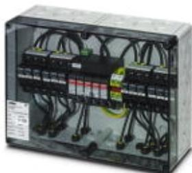
Generatoranschlusskasten für Photovoltaikanlagen bis 1000 V DC zum Anschluss von 2x 3 Strings. Mit Überspannungsschutz und SUNCLIX DC-Steckverbinder für die Eingangs- und Ausgangsseite.
