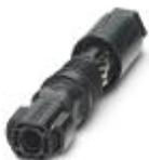
Photovoltaik-Steckverbinder, Artikelfamilie: PV-CM-S, Steckverbinder, Material Gehäuse: PPE, Farbe: schwarz, Polzahl: 1, Aderquerschnitt min.: 6 mm<sup>2</sup>, Aderquerschnitt max.: 16 mm<sup>2</sup>, Bemessungsstrom: 40 A, Anschlussart: Federkraft, Kontaktart: Stift. nur mit Werkzeug entriegelbar
