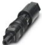
Photovoltaik-Steckverbinder, Artikelfamilie: PV-CF-S, Steckverbinder, Material Gehäuse: PPE, Farbe: schwarz, Polzahl: 1, Aderquerschnitt min.: 6 mm<sup>2</sup>, Aderquerschnitt max.: 16 mm<sup>2</sup>, Bemessungsstrom: 40 A, Anschlussart: Federkraft, Kontaktart: Buchse. nur mit Werkzeug entriegelbar
