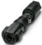
Photovoltaik-Steckverbinder, Artikelfamilie: PV-CM-S, Steckverbinder, Material Gehäuse: PPE, Farbe: schwarz, Polzahl: 1, Aderquerschnitt min.: 2,5 mm<sup>2</sup>, Aderquerschnitt max.: 6 mm<sup>2</sup>, Bemessungsstrom: 27 A, Anschlussart: Federkraft, Kontaktart: Stift. nur mit Werkzeug entriegelbar
