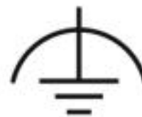
Anschluss des Schutz-Potenzialausgleichleiters
