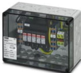
Generatoranschlusskasten für Photovoltaikanlagen bis 1000 V DC zum Anschluss von 2x 2 Strings. Mit Überspannungsschutz und Push-in-Anschluss für die Eingangs- und Ausgangsseite.
