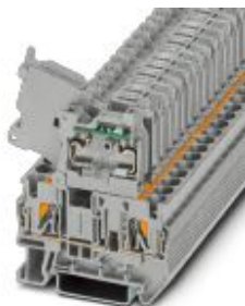
Hebelsicherungsklemme, Farbe grau, für 5 x 20 mm G-Sicherungseinsätze, mit LED für 24 V DC
