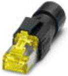
RJ45-Steckverbinder, IP20, CAT6<sub>A</sub>, 8-polig, mit QUICKON-Schnellanschlusstechnik, für 1-drähtige und 7-drähtige Adern AWG 26 ... 24, Farbe: schwarz
