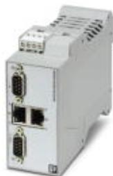
Der GW EIP/MODBUS... ermöglicht die Zwei-Wege-Kommunikation zwischen EtherNet/IP™- und Modbus-Protokollen. Umfasst zwei RJ45-Anschlüsse und zwei D-SUB-9-Anschlüsse.
