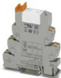
PLC-INTERFACE für hohe Einschaltströme, bestehend aus Grundklemme PLC-BPT.../ 1IC/ACT mit Push-in-Anschluss und steckbarem Miniaturrelais, zur Montage auf Tragschiene NS 35/7,5, max. Einschaltstrom bis 800 A, 1 Schließer, Eingangsspannung 24 V DC
