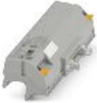
V8-Adapter für 8 x PLC-INTERFACE (14 mm), Steuerung: SPS-Systemverkabelung von Ausgangskarten, Anschluss 1: Schraubanschluss 1x, Anschluss 2: IDC/FLK-Stiftleiste 1x 14-polig, Anschluss 3: Steckanschluss (Aufraubar auf 8x PLC-INTERFACE-Klemmen), Anzahl der Kanäle: 8, Ansteuerlogik: minusschaltend
