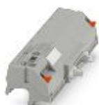
V8-Adapter für 8 x PLC-INTERFACE (14 mm), Steuerung: SPS-Systemverkabelung von Ausgangskarten, Anschluss 1: Schraubanschluss 1x, Anschluss 2: IDC/FLK-Stiftleiste 1x 14-polig, Anschluss 3: Steckanschluss (Aufraustbar auf 8x PLC-INTERFACE-Klemmen), Anzahl der Kanäle: 8, Ansteuerlogik: plusschaltend
