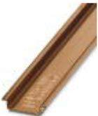
Tragschiene ungelocht, Standardprofil, Breite: 35 mm, Höhe: 7,5 mm, nach EN 60715, Material: Kupfer, unbeschichtet, Länge: 2000 mm, Farbe: kupferfarben
