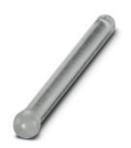
Lichtleiter vertikal 4 mm, transparent, mit Linsenkopf sphärisch 5,2 mm, Montage für Wandstärken ab 1 mm, aus Polycarbonat (UL 94-V0), Einbaulänge 45 mm, wasserdicht, IP68 (EN 50529)
