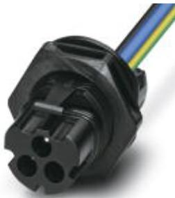
Rundsteckverbinder (geräteseitig), Artikelfamilie: PRC, Gerätesteckverbinder Hinterwand, Material Gehäuse: PPE, Farbe: schwarz, Polzahl: 3, Aderquerschnitt max.: 2,5 mm<sup>2</sup>, Nennspannung: 690 V AC, Bemessungsstrom: 24 A, Anschlussart: Crimpanschluss, Kontaktart: Stift, Kabellänge: 150
