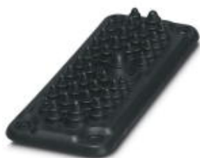
Kabeldurchführungsplatte, Anzahl der Leitungen: 37, Länge: 222 mm, Breite: 92 mm, Höhe: 29,5 mm, Leitungsaußendurchmesser: 4x 6 mm ... 10 mm, Farbe: schwarz
