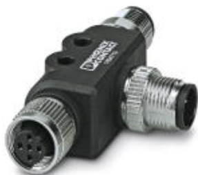
T-Verteiler, PROFIBUS DP (12 MBit/s), 5-polig, geschirmt, Buchse gerade M12, B-kodiert, auf Stecker gerade M12, B-kodiert und Stecker gerade M12, B-kodiert, Gewinde M12-Stecker Eingang nicht drehbar
