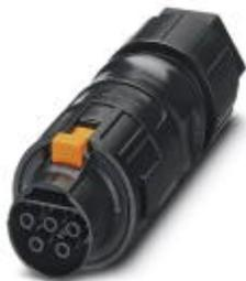
PRC-Prüfstecker, 2000 Steckzyklen, handentriegelbar, schwarz, 5-polig, 1,5 mm<sup>2</sup> ... 6 mm<sup>2</sup> / 690 V / 35 A, mit Schraubanschluss für Leitungen mit dem Außendurchmesser 8 mm ... 21 mm.
