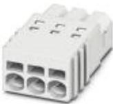
Leiterplattenstecker, Nennstrom: 6 A, Bemessungsspannung (III/2): 160 V, Nennquerschnitt: 0,5 mm<sup>2</sup>, Polzahl: 5, Rastermaß: 2,5 mm, Anschlussart: Push-in-Federanschluss, Farbe: weiß, Kontaktfläche: Zinn
