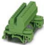
Tragschienenstecker, Nennstrom: 12 A, Bemessungsspannung (III/2): 320 V, Nennquerschnitt: 2,5 mm<sup>2</sup>, Polzahl: 10, Rastermaß: 5,08 mm, Anschlussart: Schraubanschluss mit Zughülse, Farbe: grün, Kontaktobерfläche: Zinn, Montage: Tragschiene
