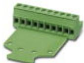
Leiterplattenstecker, Nennstrom: 12 A, Bemessungsspannung (III/2): 320 V, Nennquerschnitt: 2,5 mm<sup>2</sup>, Polzahl: 10, Rastermaß: 5,08 mm, Anschlussart: Schraubanschluss mit Zughülse, Farbe: grün, Kontaktobерfläche: Zinn
