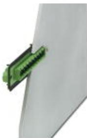
Durchführungsgrundleiste, Nennstrom: 12 A, Bemessungsspannung (III/2): 320 V, Nennquerschnitt: 2,5 mm<sup>2</sup>, Polzahl: 10, Rastermaß: 5,08 mm, Farbe: grün, Kontaktobерfläche: Zinn, Montage: Wellenlöten, Pin-Layout: Lineares Pinning
