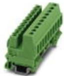
Tragschienenstecker, Nennstrom: 12 A, Bemessungsspannung (III/2): 320 V, Nennquerschnitt: 2,5 mm<sup>2</sup>, Polzahl: 10, Rastermaß: 5,08 mm, Anschlussart: Schraubanschluss mit Zughülse, Farbe: grün, Kontaktobерfläche: Zinn, Montage: Tragschiene
