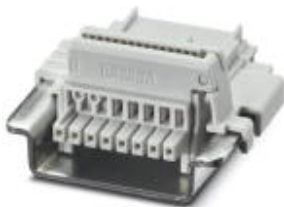
Konektory sběrnice na nosnou lištu, počet pólů: 8, rozteč: 2,54 mm, barva: světle šedá, 8 paralelních kontaktů
