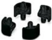
Adapter zum stapeln mehrerer UCS-Gehäuse einer Größe, Material: TPE-U, Farbe: schwarz, ähnlich RAL 9005, wird in den Schraublöchern des Gehäuses gehalten
