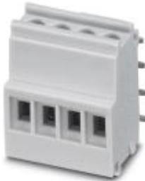
Leiterplattenklemme, Rastermaß: 3,5 mm, Polzahl: 4, Farbe: lichtgrau, Pin-Layout: Lineares Pinning, Pinlänge [P]: 3 mm. Artikel mit seitlichem Pinabgang
