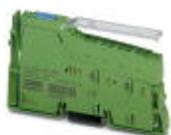
Inline, Digitaleingabeklemme, Digitale Eingänge: 8, 24 V DC, Anschlusstechnik: 1-Leiter, Übertragungsgeschwindigkeit im Lokalbus: 500 kBit/s, Schutzart: IP20, inklusive Inline-Stecker und Beschriftungsfeld
