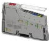
Inline, Digitalausgabeklemme, Digitale Ausgänge: 1, 230 V AC, 500 mA, Anschlusstechnik: 3-Leiter, Übertragungsgeschwindigkeit im Lokalbus: 500 kBit/s, Schutzart: IP20, inklusive Inline-Stecker und Beschriftungsfeld
