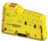
Inline ECO, Sicherheitsmodul, Digitale Eingänge: 4 (für 2 Sensorkreise (1- oder 2-kanalig, antivalent/äquivalent)), zum sicherheitsgerichteten Abschalten der Segmentspannung über die Potenzialrangierung, Übertragungsgeschwindigkeit im Lokalbus: 500 kBit/s, Schutzart: IP20, inklusive Inline-Steckern und Beschriftungsfeldern
