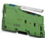
Inline, Digitaleingabeklemme, Digitale Eingänge: 4, 24 V DC, Anschlusstechnik: 3-Leiter, Übertragungsgeschwindigkeit im Lokalbus: 500 kBit/s, Schutzart: IP20, inklusive Inline-Stecker und Beschriftungsfeld
