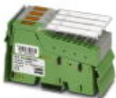
Inline, DALI-Master, Multi-Master-fähig, integriertes DALI-Netzteil, sichere galvanische Trennung, Übertragungsgeschwindigkeit im Lokalbus: 500 kBit/s, Schutzart: IP20, inklusive Inline-Steckern und Beschriftungsfeldern
