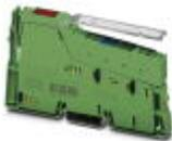
Inline, Digitalausgabeklemme, Digitale Ausgänge: 4, 24 V DC, 500 mA, Anschlusstechnik: 3-Leiter, Übertragungsgeschwindigkeit im Lokalbus: 500 kBit/s, Schutzart: IP20, inklusive Inline-Stecker und Beschriftungsfeld
