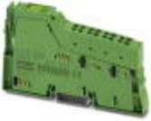
Inline ECO, Temperaturerfassungsklemme, Analoge UTH-Eingänge: 4 (Typ J), Anschlusstechnik: 2-Leiter, Übertragungsgeschwindigkeit im Lokabus: 500 kBit/s, Schutzart: IP20, inklusive Inline-Stecker
