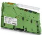
Inline, MP-Bus-Masterklemme zum Anschluss von MP-Bus-Geräten, Übertragungsgeschwindigkeit im Lokalbus: 500 kBit/s, Schutzart: IP20, inklusive Inline-Stecker und Beschriftungsfeld
