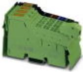
Inline, Kopplerklemme, zur Erweiterung des Inline-Lokalbusses, Übertragungsgeschwindigkeit im Lokalbus: 500 kBit/s / 2 MBit/s, Schutzart: IP20, inklusive Inline-Steckern und Beschriftungsfeldern
