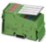
Inline, Digitalausgabeklemme, Digitale Ausgänge: 8, 24 V DC, 500 mA, Anschlusstechnik: 4-Leiter, Übertragungsgeschwindigkeit im Lokalbus: 500 kBit/s, Schutzart: IP20, inklusive Inline-Steckern und Beschriftungsfeldern
