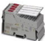
Inline, Relaisklemme, Relaisausgang: 4 (potenzialfreie Kontakte), 24 V DC / 230 V AC, 3 A, zum Schalten von ohmschen Lasten, Übertragungsgeschwindigkeit im Lokalbus: 500 kBit/s, Schutzart: IP20, inklusive Inline-Steckern und Beschriftungsfeldern
