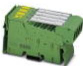
Inline, Analogausgabeklemme, Analoge Ausgänge: 8, 0 V ... 10 V, -10 V ... 10 V, 0 V ... 5 V, -5 V ... 5 V, Anschlusstechnik: 2-Leiter, Übertragungsgeschwindigkeit im Lokalbus: 500 kBit/s, Schutzart: IP20, inklusive Inline-Steckern und Beschriftungsfeldern
