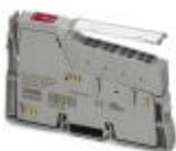
Inline, Relaisklemme, Relaisausgang: 1 (potenzialfreie Kontakte), 24 V AC / 230 V AC, 3 A, zum Schalten von ohmschen Lasten, Übertragungsgeschwindigkeit im Lokalbus: 500 kBit/s, Schutzart: IP20, inklusive Inline-Stecker und Beschriftungsfeld
