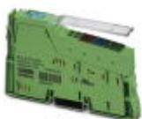
Inline, Digitaleingabeklemme, Digitale Eingänge: 2 (NPN), 24 V DC, Anschlusstechnik: 4-Leiter, Übertragungsgeschwindigkeit im Lokalbus: 500 kBit/s, Schutzart: IP20, inklusive Inline-Stecker und Beschriftungsfeld
