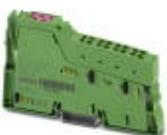
Inline ECO, Digitalausgabeklemme, Digitale Ausgänge: 4, 24 V DC, 500 mA, Anschlusstechnik: 3-Leiter, Übertragungsgeschwindigkeit im Lokalbus: 500 kBit/s, Schutzart: IP20, inklusive Inline-Stecker
