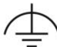
Anschluss des Schutz-Potenzialausgleichleiters
