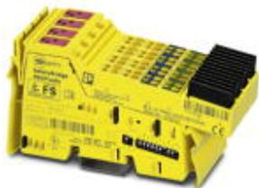
I/O-Komponente sicherheitsgerichtet, digitales Ausgangsmodul mit 4 sicheren Ausgängen plus- und minusschaltend; für das SafetyBridge-System, PROFIsafe und INTERBUS-Safety; bis zu SILCL 3, Kat.4/PL e, SIL 3, steckbarer Zugfederanschluss mit Entladessteckern
