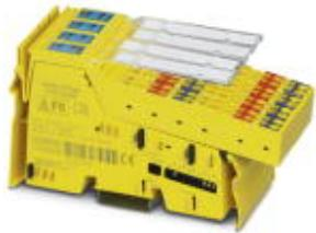
Sicherheitsgerichtetes digitales Eingangsmodul, Schutzart IP20, für das SafetyBridge V3- und das PROFIsafe-System. Das Modul verfügt über 8 sichere digitale Eingänge bei zweikanaliger Belegung oder 16 sichere digitale Eingänge bei einkanaliger Belegung
