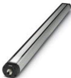
LED-Maschinenleuchte, 24 V DC, Abstrahlwinkel 75 °/95 °, Farbtemperatur 5000 K, Länge 1070 mm, Durchmesser 70 mm, M12-Steckverbinder, Leuchtgehäuse: Aluminium eloxiert, Glasscheibe: Einscheiben-Sicherheitsglas (ESG, thermisch vorgespanntes Floatglas), schwenkbar, resistent gegen Kühl- und Schmiermittel
