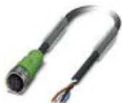
Sensor-/Aktor-Kabel, 4-polig, PUR halogenfrei, schwarzgrau RAL 7021, freies Leitungsende, auf Buchse gerade M12, A-kodiert, Kabellänge: 3 m
