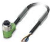
Sensor-/Aktor-Kabel, 4-polig, PUR halogenfrei, schwarzgrau RAL 7021, freies Leitungsende, auf Buchse gewinkelt M12, A-kodiert, Kabellänge: 1,5 m
