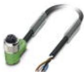
Sensor-/Aktor-Kabel, 4-polig, PUR halogenfrei, schwarzgrau RAL 7021, freies Leitungsende, auf Buchse gewinkelt M12, A-kodiert, Kabellänge: 5 m
