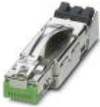
RJ45-Steckverbinder, Schutzart: IP20, Polzahl: 8, 1 GBit/s, CAT5 (IEC 11801:2002), Material: Zink-Druckguss, Anschlussart: IDC-Schnellanschluss, Anschlussquerschnitt: AWG 26- 24, Kabelabgang: gerade, Farbe: grün
