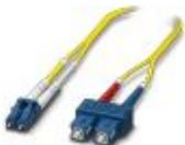
OS2-Duplex-Jumper, Singlemode, LC-SC, UPC-Schliff, Länge 2 m
