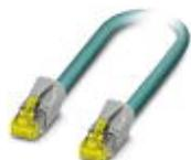
Patch-Kabel, CAT6<sub>A</sub>, 4-paarig, geschirmt, nicht gekreuzte Verbindung (Line), beidseitig konfektioniert mit RJ45/IP20-Steckverbindern, Material Außenmantel: PUR, Länge: 2,0 m
