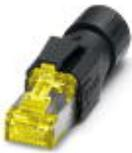
RJ45-Steckverbinder, IP20, CAT6<sub>A</sub>, 8-polig, mit QUICKON-Schnellanschlusstechnik, für 1-drähtige und 7-drähtige Adern AWG 26 ... 24, Farbe: schwarz
