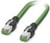
PROFINET-Patch-Kabel, geschirmt, Sternvierer, AWG 22 flexibel (7-drähtig), grün, RJ45-Stecker/IP20, gerade, auf RJ45-Stecker/IP20, gerade, Länge: 5 m
