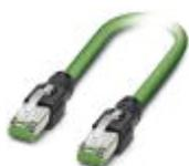
PROFINET-Patch-Kabel, geschirmt, Sternvierer, AWG 22 flexibel (7-drähtig), grün, RJ45-Stecker/IP20, gerade, auf RJ45-Stecker/IP20, gerade, Länge: 1,0 m
