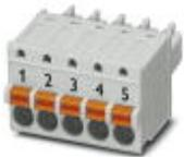
Leiterplattenstecker, Nennstrom: 8 A, Bemessungsspannung (III/2): 160 V, Nennquerschnitt: 1,5 mm<sup>2</sup>, Polzahl: 5, Rastermaß: 3,81 mm, Anschlussart: Push-in-Federanschluss, Farbe: lichtgrau, Kontaktoberfläche: Zinn
