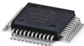
Čip rozšiřující sériový registr pro INTERBUS Slave-protokolový čip
