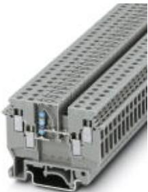
1-stöckige Klemme mit beidseitigem Doppelanschluss, mit eingebautem Widerstand 5,1 kΩ, ± 0,1 %, 0,6 W, Querschnitt: 0,2 ... 2,5 mm², Breite: 6,2 mm, Farbe: grau
