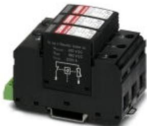
Blitzstrom- / Überspannungsableiter für 2-polige isolierte Gleichspannungssysteme 600 V DC, für Tragschienenmontage, 3-poliges Basiselement mit Fernmeldekontakt, drei steckbare temperaturüberwachte Schutzelemente, Statusmeldung an jedem Stecker.
